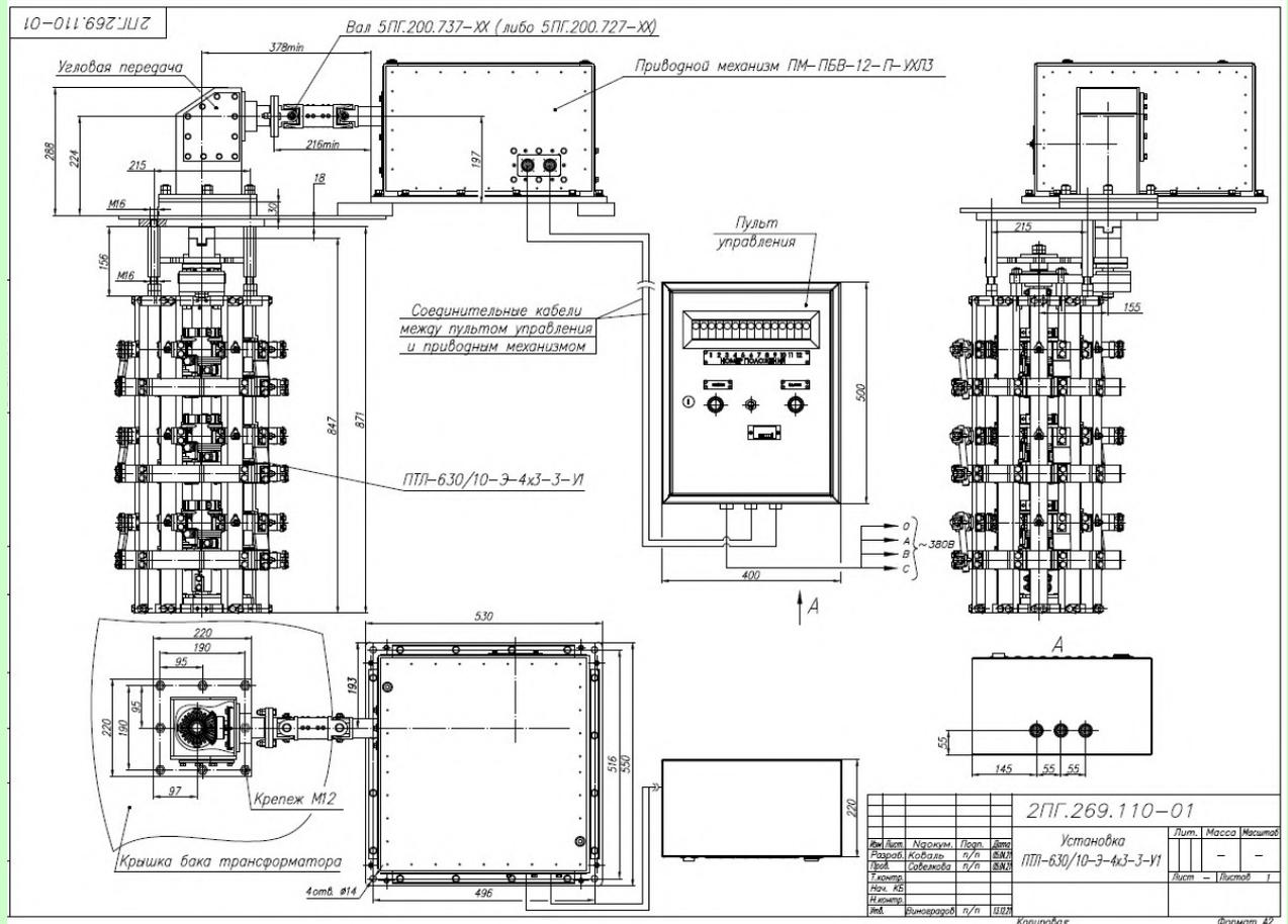
**Приводной механизм с много шестеренчатым редуктором и расположением ручки ручного вращения непосредственно на силовом валу (с условно снятым боковым листом кожуха)**
