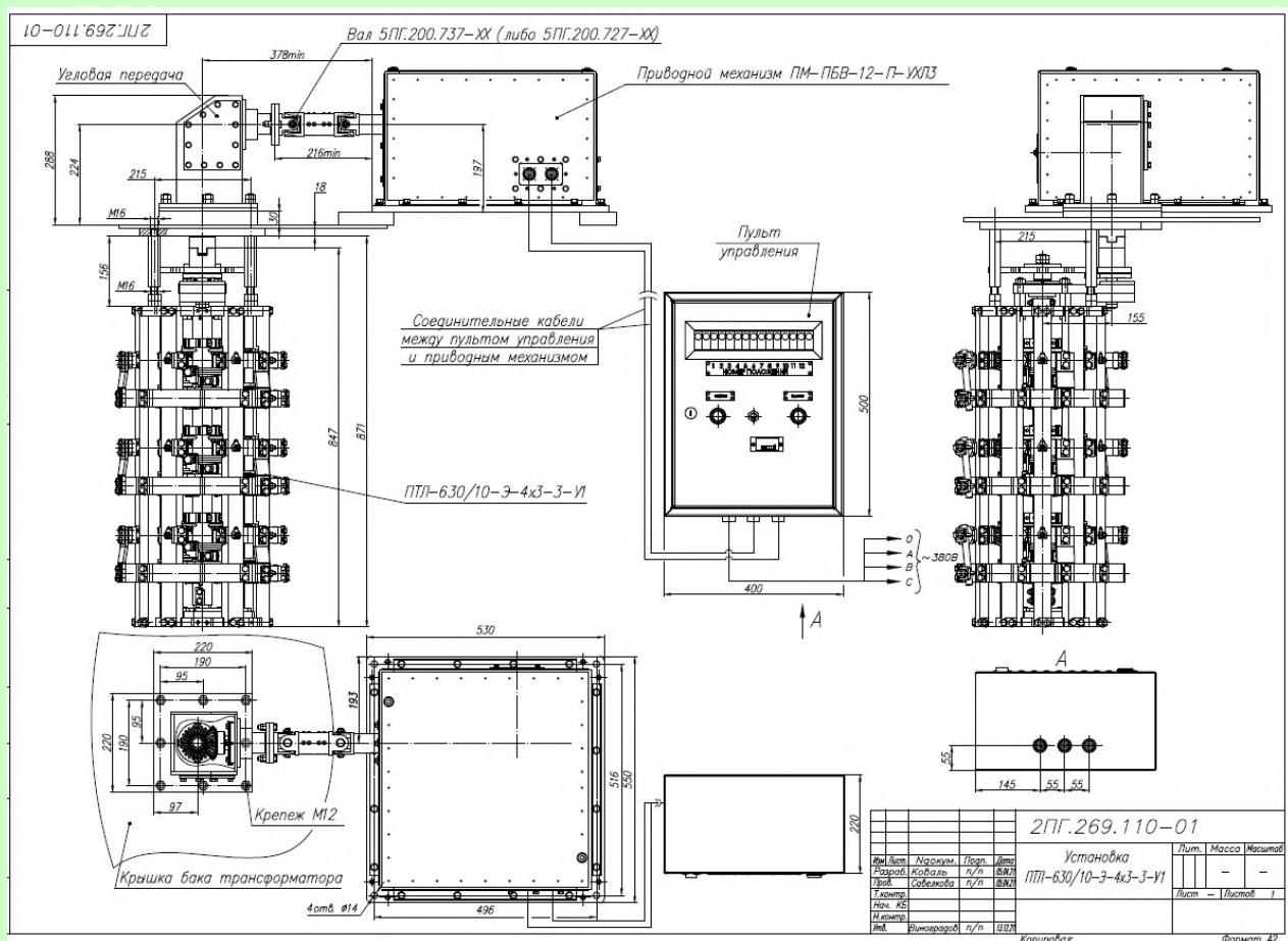
**Приводной механизм с много шестеренчатым редуктором и расположением ручки ручного вращения непосредственно на силовом валу (с условно снятым боковым листом кожуха)**
